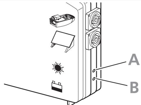
Der Ladezustand der Akku-Einheit wird in einem Intervall von 20s angezeigt.
